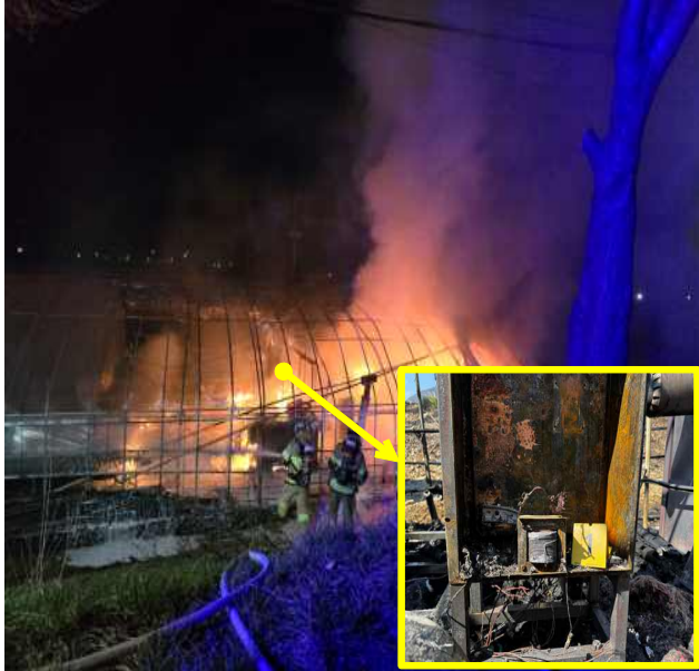
(양액기 제어판) 밤 내 전자 선전에서 미확인 단락에 의해 전선 피복에 착화된 후 화재 발생
