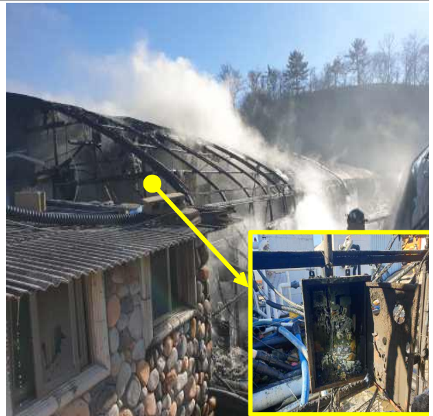
(전기보일러 과부하)에 의한 분전반의 차단기가 작동되는 과정에서 아크 발생으로 분전함 내부 화재 발생
